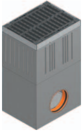
odtoková vpust, 2-dílná, s pozinkovaným košem, s litinovým krytem SW 2 x 140/20, černý, třída F 900
