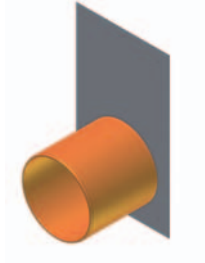
čelní stěna s nátrubkem PVC DN 200
