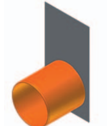
čelní stěna s nátrubkem PVC DN 200
