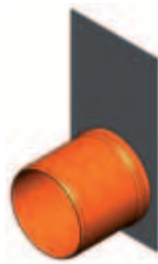
čelní stěna s nátrubkem PVC DN 200
