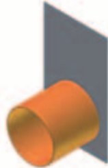
čelní stěna s nátrubkem PVC DN 200
