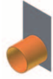
čelní stěna s nátrubkem PVC DN 200
