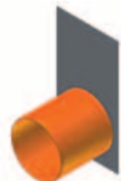
čelní stěna s nátrubkem PVC DN 200
