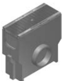
odtoková vpusť s pozinkovaným košem s pororoštem oka 30/10, třída B 125
