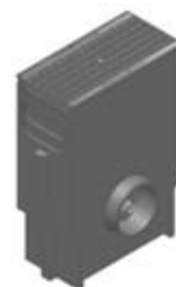
odtoková vpust s pozinkovaným košem, s pororoštem oka 30/30, pozinkovaný, třída B 125
