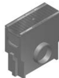
odtoková vpust s pozinkovaným košem, s pororoštem oka 30/10, pozinkovaný, třída B 125
