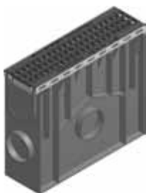
odtoková vpust s plastovým košem, s GUGI litinovým pororoštem oka 20/30, třída C 250, černý
